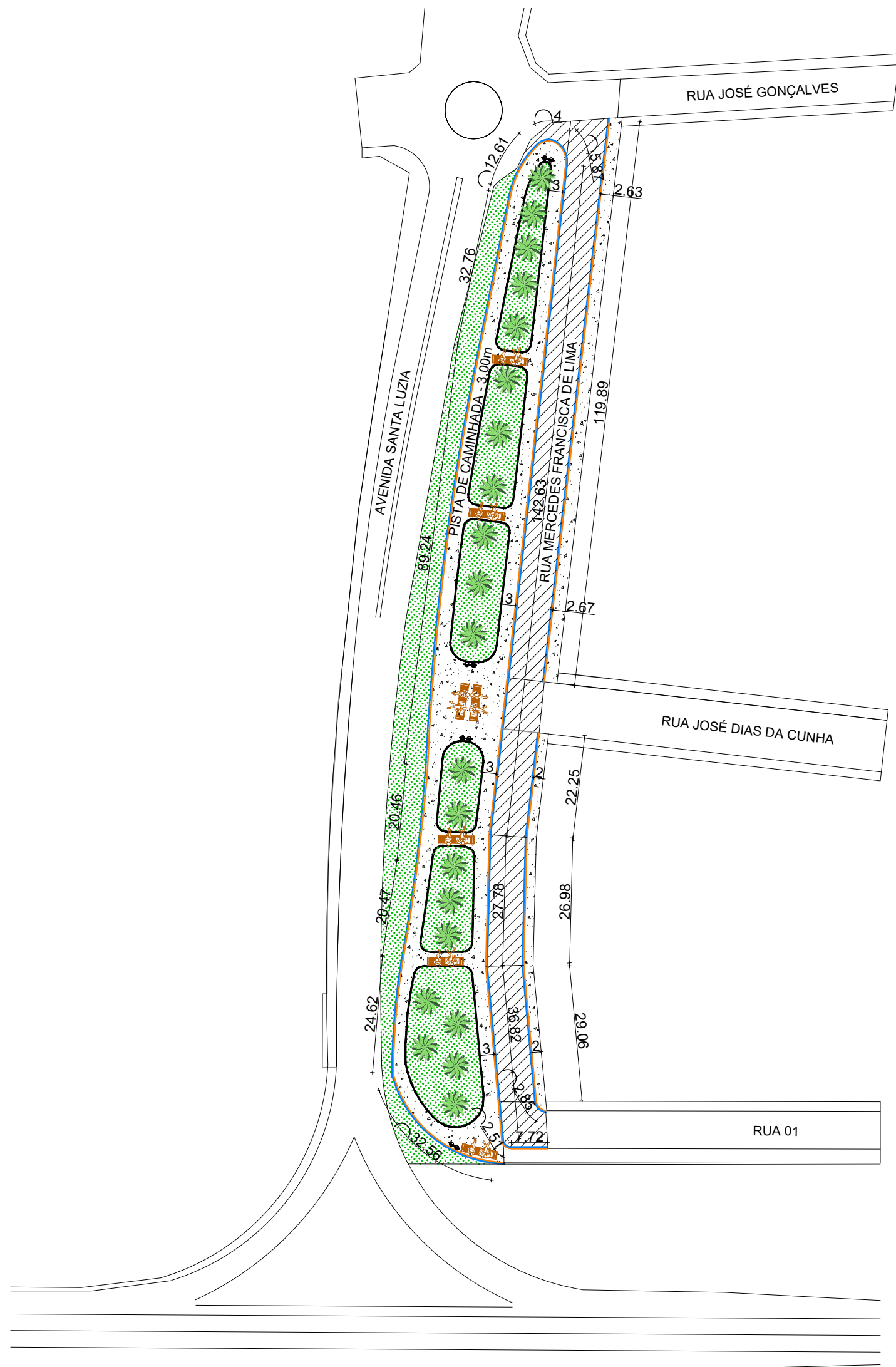
PLANTA DE MEIO FIO E CALÇADAS ESCALA: 1/1000
